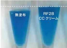
[試験方法] 水を入れた試験管に、ろ紙を貼り、その上からRF28 CCクリームを塗布。一定時間経過後の水の残量を比較。
